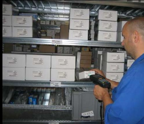
. 6 PDA Datalogic Scorpio X3 laser 1D avec poignet et clavier alphanumérique, des holsters pour que les opérateurs puissent les fixer à leurs ceintures, et 2 socles de recharge 4 positions.
